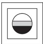
Abdeckclip für die Abdeckung des vertikalen Erfassungsbereiches bei UP-/AP-Montage zum Ausblenden von Störquellen unterhalb des Gerätes (z.B. Kleintiere etc.).
