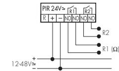
Präsenz- und helligkeitsabhängige Lichtsteuerung sowie präsenzabhängige HLK-Steuerung. Lichtwert kann anstelle von Relais 1 als variabler Widerstand ausgegeben werden.
