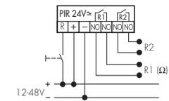
Über einen separaten Remote-Eingang (R) kann das Licht bei Bedarf manuell ein- bzw. ausgeschaltet werden.
